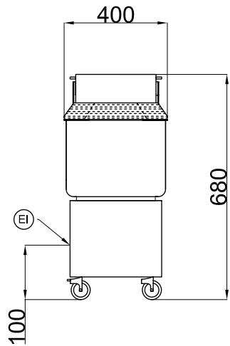
EI = Conexión eléctrica (energía)
